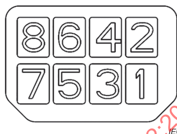
Figure 5b) – Type II (avec les biseaux de détrompage sur le côté long)
